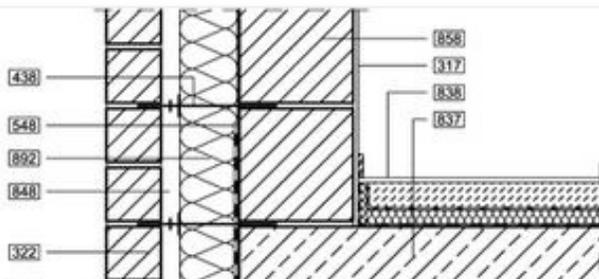
Außenwand Mauerwerk mit hinterlüfteter Vorsatzschale, Kellerwand Mauerwerk
